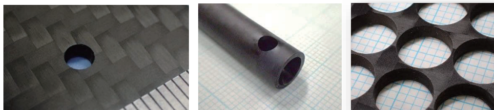
図 CFRPクロスプライ積層板に対する穴加工例
