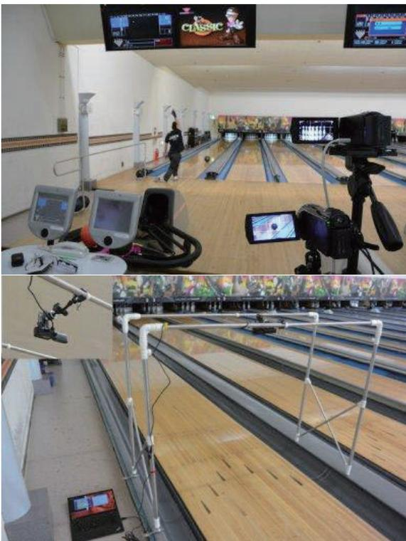
視覚障害者ボウラーの単独練習を可能にするため、残ピンカウントシステムを実現しました。後方に設置したビデオカメラによる動画像から、スイープバーの降りてくるタイミングをパターンマッチングで認識し、その瞬間のピンヘッド位置の明るさを測定することで残ピン番号などを音声合成で読み上げます。
